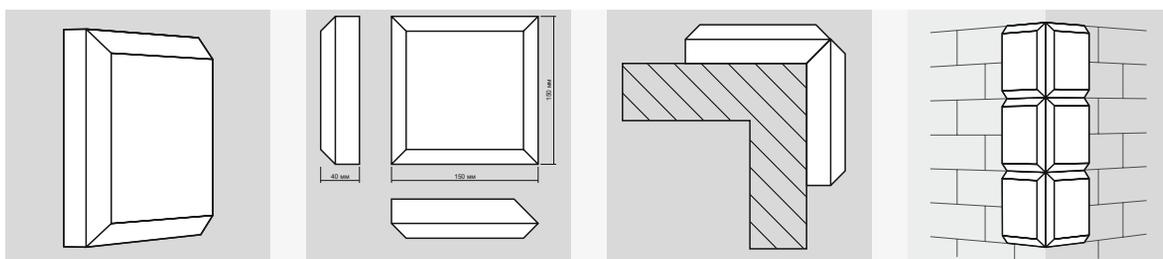
рис.3 Комбинированное исполнение углов, или тип K.
