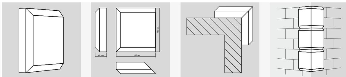
рис.2 Два угла по 45°, или тип P.
