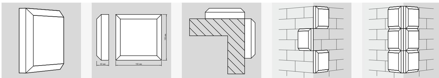
рис.1 Фронтальное исполнение, или тип F.
